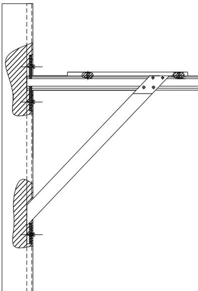
Montage Konsole an Träger Leicht
