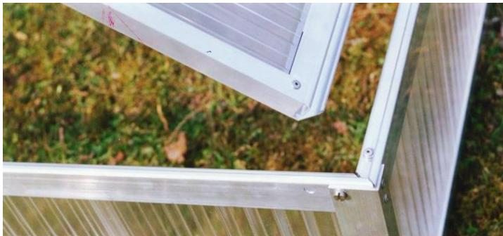
In den fertigen Kasten werden die mitgelieferten Fenster eingehängt. Die Scharnierseite der Fenster hat abgeschrägte Ecken. Wenn Sie die Fenster steil aufstellen, dann verhaken sich beim Schließen die Aluminiumprofile ineinander und bilden so ein Scharnier. Zum Aushängen klappen Sie das Fenster nach hinten und heben es ab.
