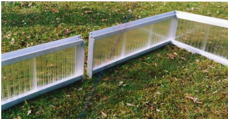
Die Teile werden aneinandergesetzt und oben gemeinsam mit der Querstrebe verschraubt. Dazu verwenden Sie die Schrauben M6 x 20 mm. Für die unterste Verschraubung wird eine Schraube M6 x 10 mm verwendet. Im zweiten Loch von unten gesehen wird nur dann eine Schrägstrebe mitverschraubt, wenn Sie einen „LÜFTCHECK“ einbauen.
