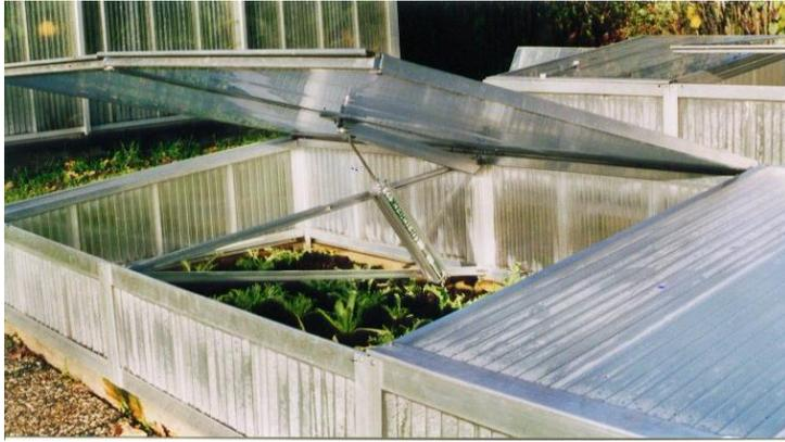
Der „LÜFTCHECK“ hebt mit der am „LÜFTCHECK“-Arm befestigten Platte immer zwei Fenster.
