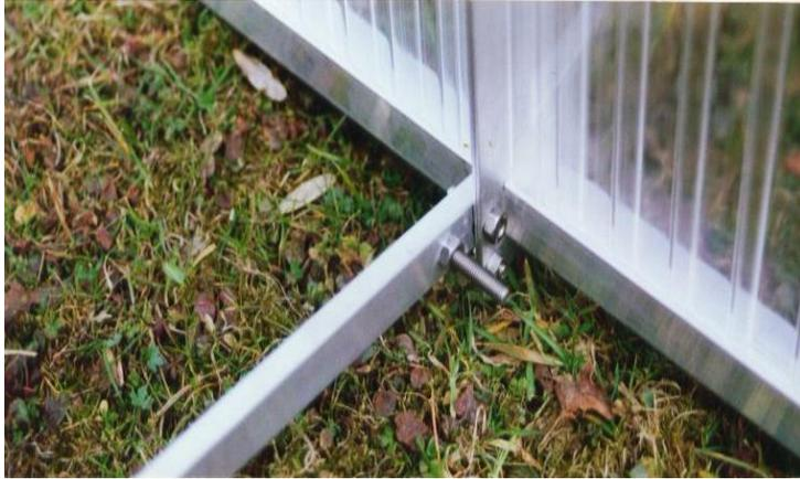
Beim Einbau eines „LÜFTCHECKS“ wird bei einem 350 mm hohen Frühbeet die Querstrebe an der Rückwand im zweiten Loch von unten angeschraubt. Bei einem 550 mm hohen Frühbeet wird diese Strebe ca. in der Mitte der Rückwand (nie unten) angeschraubt. Das dafür vorgesehene Loch ist in den Verbindungswinkeln vorhanden. An der Querstrebe wird bereits von uns eine lange Schraube eingesetzt. Sie muss wie am Foto nach rechts zeigen.
