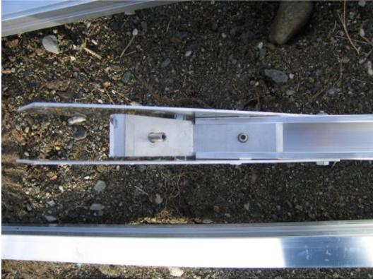
Träger mit Trägerspannplatten und eingebauten Verstärkungsprofil (Bei Träger M –NR 2 und S NR3)
